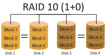
RAID 10 сочетает в себе преимущества (и недостатки) RAID 0 и RAID 1 в одной системе. Он обеспечивает безопасность за счет зеркального отображения всех данных на вторичном наборе дисков (диски 3 и 4 на следующем рисунке) при использовании чередования для каждого набора дисков для ускорения передачи данных.
