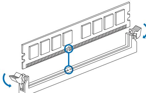
步驟2: 垂直將DIMM牢固地插入插槽，直到固定夾扣跳回原位，並且DIMM正確就位。
