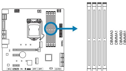
1단계: 고정 클립을 눌러 바깥으로 향하게 하여, 메모리를 설치할 수 있게 DIMM 슬롯을 열어줍니다. 메모리 흄의 위치가 슬롯 흄의 위치와 일치하도록 확인합니다.
