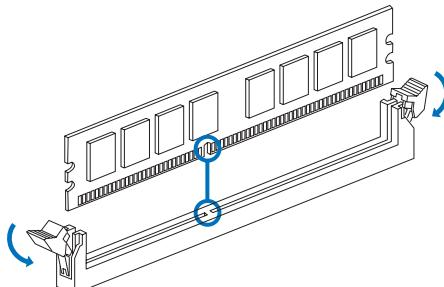
Шаг 2: Вставьте DIMM вертикально плотно в слот так, чтобы фиксирующие зажимы защелкнулись и модуль DIMM установился должным образом.
