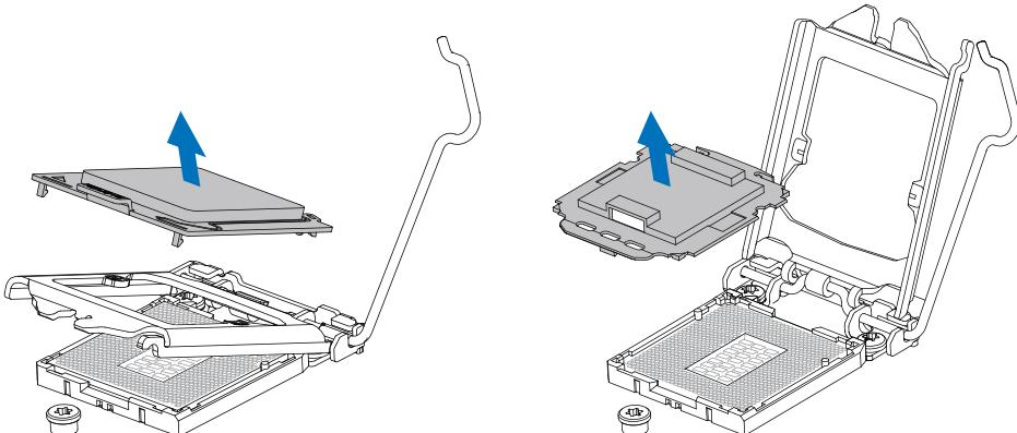
步驟4: 按照箭頭的指示方向，將CPU上的切口對準插槽上相對應的位置，然後將CPU放入插槽處。
