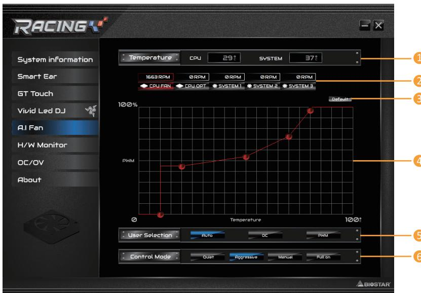
1. 溫度(Temperature)：顯示當前CPU和系統溫度。
