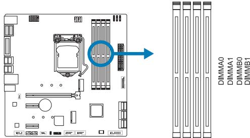
步驟1: 向外按壓固定夾以解鎖DIMM插槽。對準插槽上的DIMM，以使DIMM上的缺口符合與插槽上的缺口符合。
