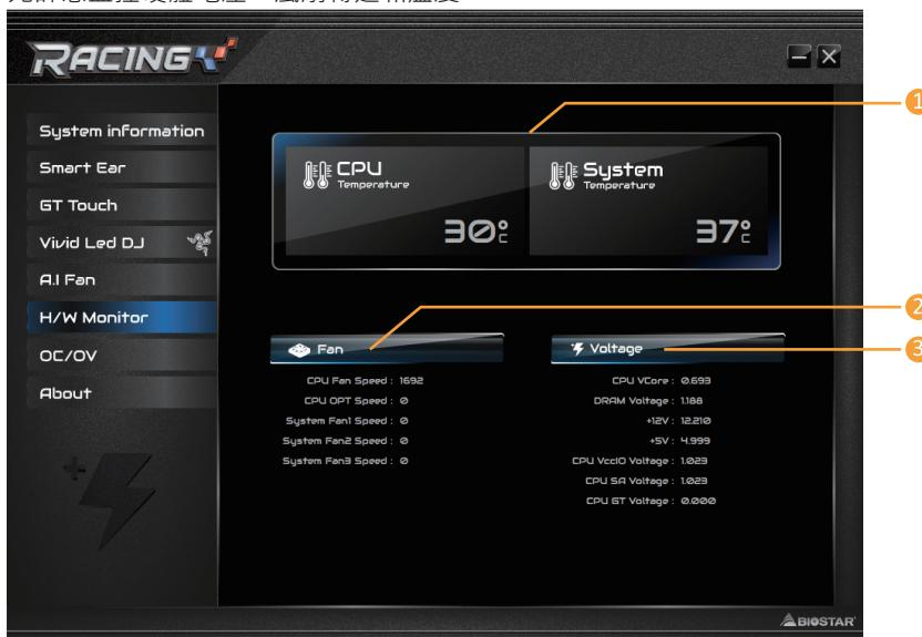
1. 處理器溫度/系統溫度(CPU/System Temperature)：顯示當前CPU和系統溫度。
