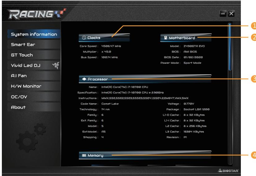
1. **Clocks (Часы):** показывает частоту ядра, множитель и частоту шины.
