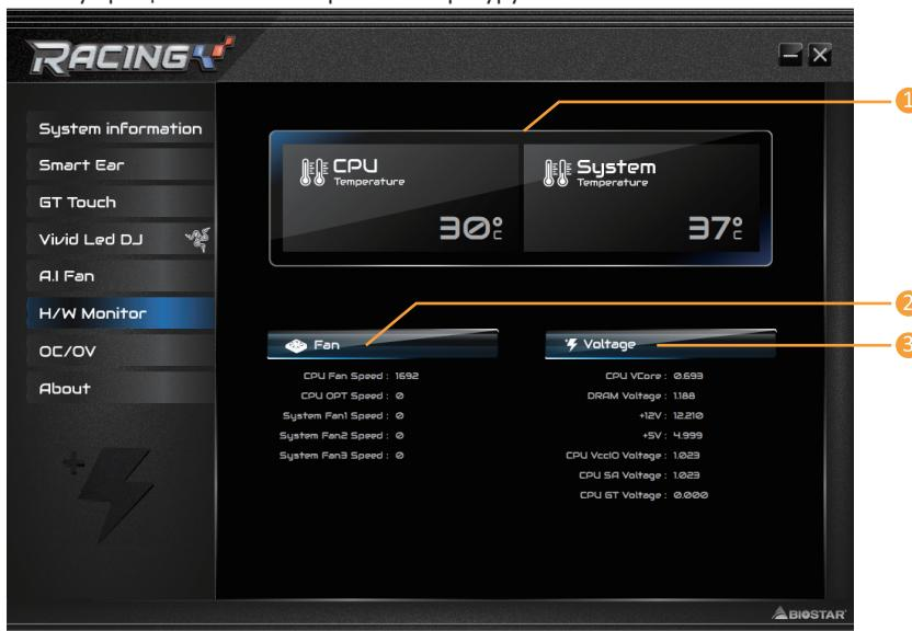
**1. CPU Temperature/System Temperature (Температура ЦП/Температура системы):** показывает текущую температуру ЦП и системы.
