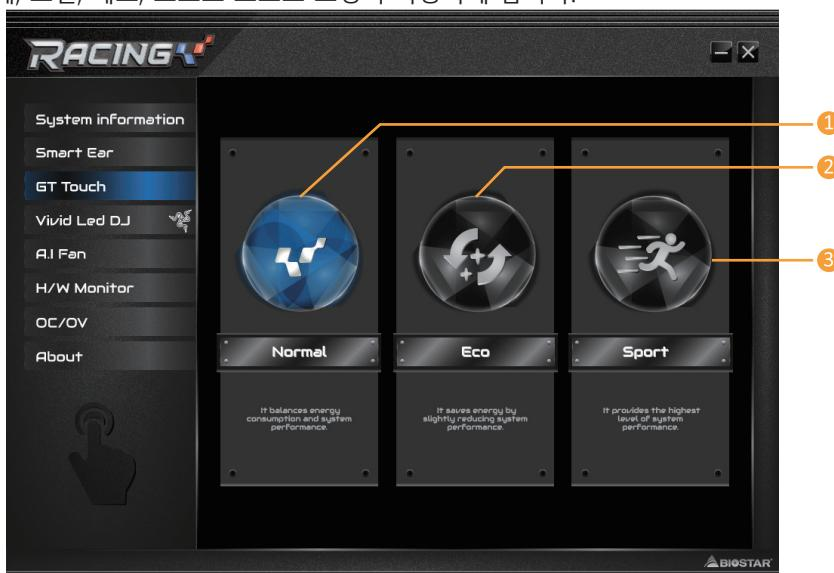
1. **노멀 모드(Normal Mode)**: 전력 소비와 시스템 성능의 균형을 맞춥니다.
