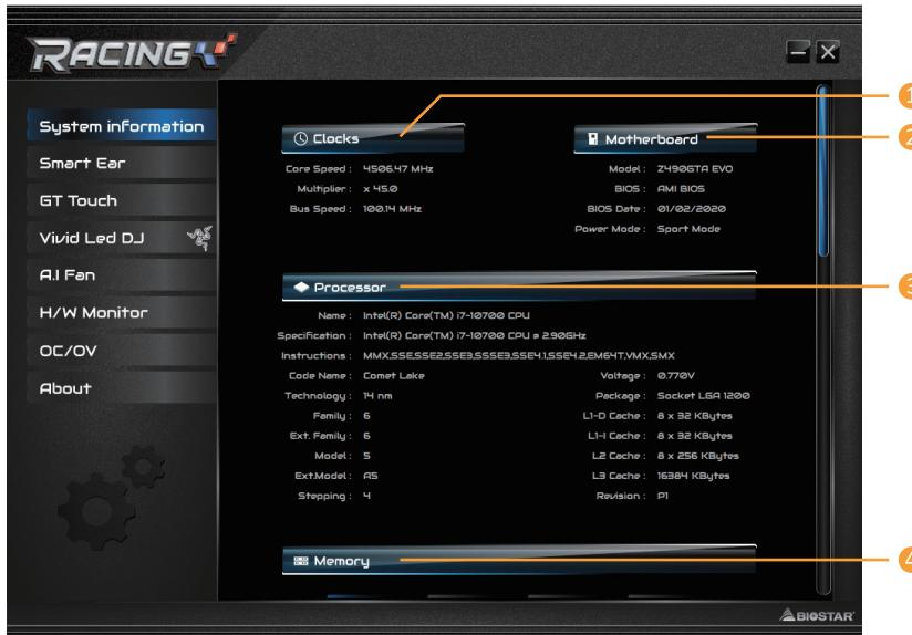
1. 時脈頻率(Clocks)：顯示核心頻率、倍頻和匯流排速度。
