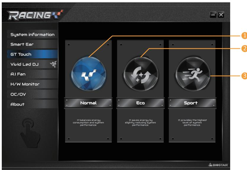
1. 標準模式(Normal)：自動平衡系統性能與電源消耗。
