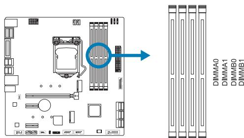
Шаг 1: Разблокируйте слот DIMM, нажав на фиксирующие зажимы наружу. Выровняйте модуль DIMM в слоте таким образом, чтобы выемка на модуле DIMM совпадала с разрывом в слоте.
