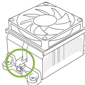
步骤2: 将另一边的固定夹向下压，扣住支架上的塑胶凸耳。然后固定，使风扇和散热片扣住支架底座。
