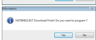
6. 完成下载后，屏幕弹出提示您刷新BIOS的对话框，点击“Yes”开始刷新。
