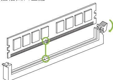
步骤2: 垂直插入DIMM并固定好, 直到固定夹跳回原位, DIMM就位。
