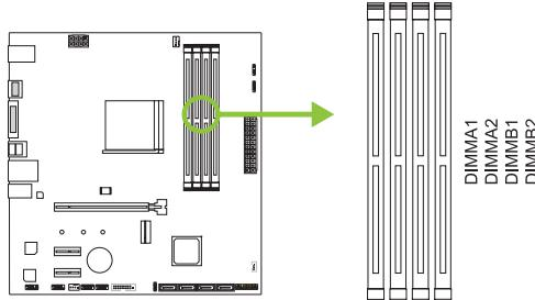
步骤1: 向外推开固定夹, 打开DIMM插槽。将DIMM按顺序放在插槽上, DIMM上的切口须与插槽凹口匹配。
