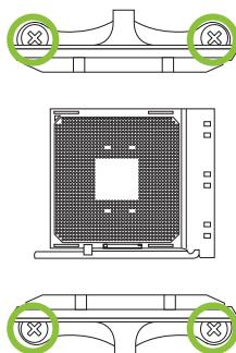
步骤2: 将散热片和风扇组件放置于CPU上方, 调整方向使风扇电缆最靠近CPU风扇连接器, 参照示意图之顺序将螺丝锁入, 完成散热片风扇的安装。
