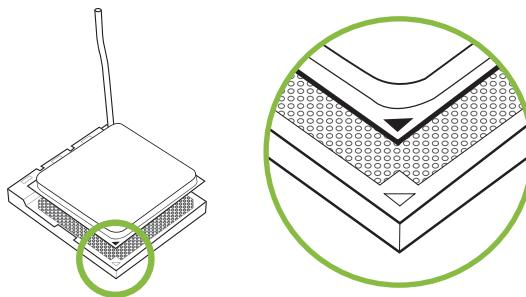
步骤4: 固定CPU，将拉杆闭合。
