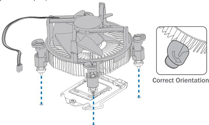
Шаг 2: Одновременно нажмите на два крепежных элемента, которые расположены по диагонали, чтобы зафиксировать вентилятор ЦП в сборе. При фиксации каждого крепежного элемента должен быть слышен щелчок.
