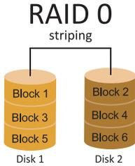
В системе RAID 0 данные разделены на блоки, которые записываются на все диски в массиве. Одновременное использование нескольких дисков (как минимум 2) обеспечивает превосходную производительность ввода-вывода. Эту производительность можно дополнительно повысить за счет использования нескольких контроллеров, в идеале одного контроллера на диск.
