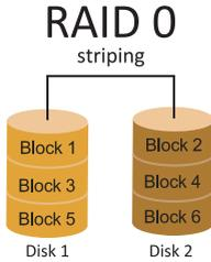
在RAID 0中，同一時間內向多塊磁碟寫入數據，通過把數據分成多個數據塊 (Block) 並執行寫入/讀出多個磁碟以提高磁碟的速度分散到所有的硬碟中同時進行讀寫，在整個磁碟陣列建立過程中，以系統環境為基礎，指數的大小決定了每塊磁碟的容量。此技術可減少整個磁碟的存取時間和提供高的頻寬。
