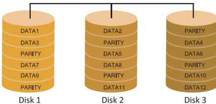
RAID 5數據塊和奇偶塊訊息跨3塊或更多塊驅動器。奇偶校驗數據分散分佈在磁碟陣列的全部硬碟。容錯的維護是由確保數據塊傳輸奇偶塊訊息的實現，此訊息被放置在不同於那些自身可以儲存訊息的驅動碟裡。
