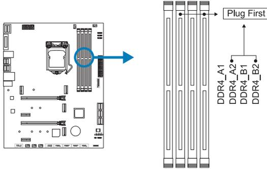
1단계: 고정 클립을 눌러 바깥으로 향하게 하여, 메모리를 설치할 수 있게 DIMM 슬롯을 열어줍니다. 메모리 홈의 위치가 슬롯 홈의 위치와 일치하도록 확인합니다.
