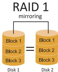
Данные сохраняются дважды путем записи их как на диск данных (или набор дисков с данными), так и на зеркальный диск (или набор дисков). Если диск выходит из строя, контроллер использует либо диск с данными, либо зеркальный диск для восстановления данных и продолжает работу. Для массива RAID 1 требуется не менее 2 дисков.
