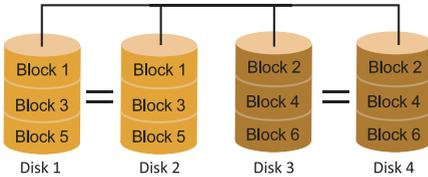
RAID 10模式是對RAID 0/ RAID 1兩種不同模式的結合，可以同時支援帶區集和鏡像，這樣既可以提升速度又可以加強數據的安全性。
