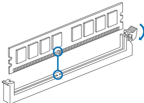
Шаг 2: Вставьте DIMM вертикально плотно в слот так, чтобы фиксирующие зажимы защелкнулись модуль DIMM установился должным образом.
