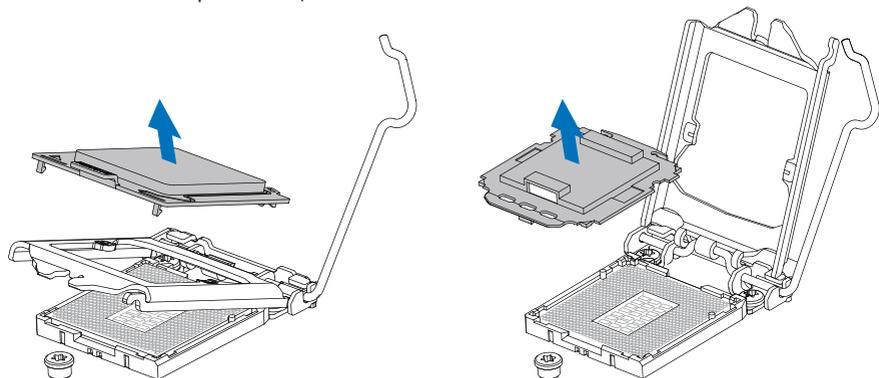
Шаг 4: Удерживая процессор большим и указательным пальцами, ориентируйте его, как показано на рисунке. Совместите выемки с socketом. Опустите процессор прямо вниз, не наклоняя и не сдвигая процессор в socketе.
