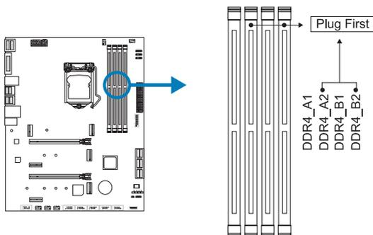
Шаг 1: Разблокируйте слот DIMM, нажав на фиксирующие зажимы наружу. Выровняйте модуль DIMM в слоте таким образом, чтобы выемка на модуле DIMM совпала с разрывом в слоте.
