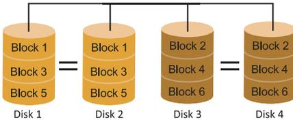
RAID 10 сочетает в себе преимущества (и недостатки) RAID 0 и RAID 1 в одной системе. Он обеспечивает безопасность за счет зеркального отображения всех данных на вторичном наборе дисков (диски 3 и 4 на следующем рисунке) при использовании чередования для каждого набора дисков для ускорения передачи данных.
