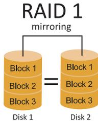
每次讀寫實際上是在磁碟陣列系統中(RAID 1)，通過2個磁碟驅動器並行完成的。RAID 1或鏡像模式能夠自動對數據進行備份，通過將一塊硬盤中的數據完整複製到另外一塊硬盤實現數據的冗餘。假如由於硬碟的損壞，導致驅動失敗，或是容量過大，RAID1可以提供一個數據備份。RAID 技術可以應用於高效方案，或者可以作為自動備份形式，代替冗長的，高價的且不穩定的備份形式。
