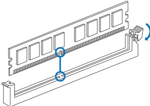
步驟2: 垂直將DIMM牢固地插入插槽，直到固定夾扣跳回原位，並且DIMM正確就位。
